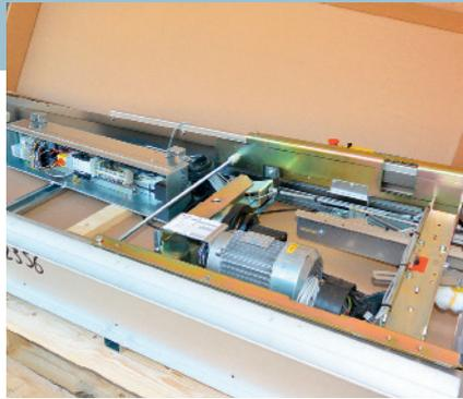
**2** Alle Modelle, die das Unternehmen verbaut, benötigen keinen Maschinenraum. Die gesamte Technik ist im Schacht untergebracht. Der Plattformlift fährt mit einem patentierten Spindelsystem, ohne dass Öl austreten kann.
